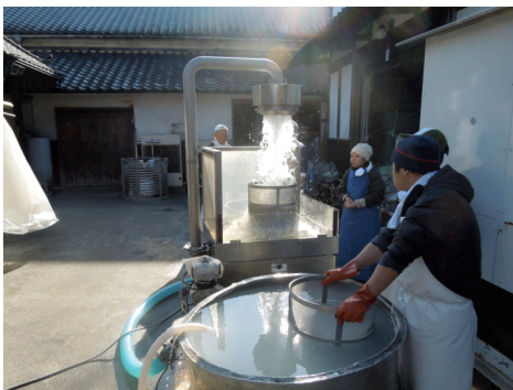
洗米の最中です。奥に写っているのが特注の自動洗米機。
