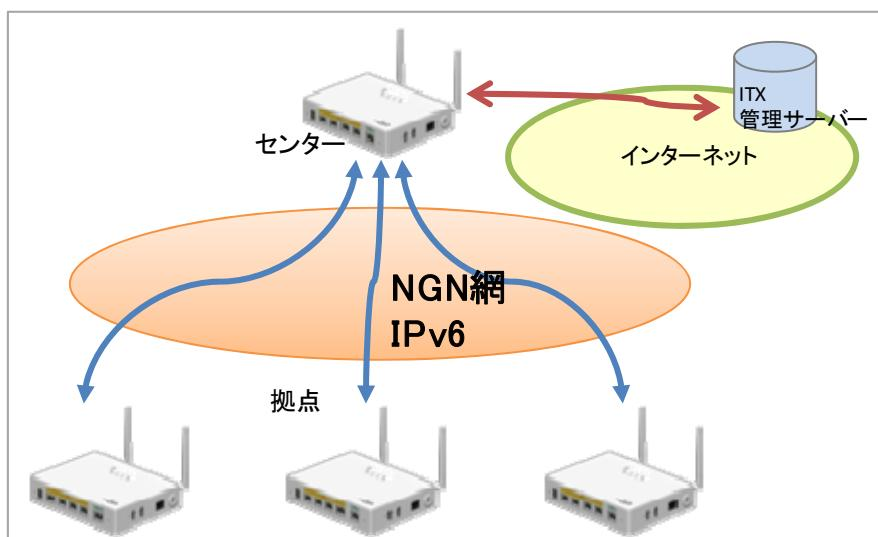
NTT フレッツ NGN 網内で IPv6 アドレスを利用した VPN 通信です。インターネットを経由しない為、低遅延・高速通信・高セキュリティを実現します。
