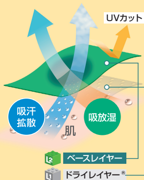
ラミースピン® 生地構造図
