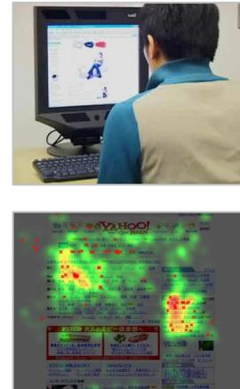
図 3: 視線の動きを計測するアイトラッキングシステムを導入し、レイアウトの検証や広告の認知効果検証などに活用
