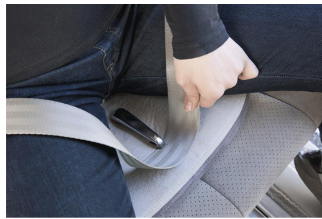
2. 通常通りにシートベルトを締めた後、お腹側のベルトを座面のフックに掛け、シートベルトが太ももをサポートするように張りを調整し、固定します。
