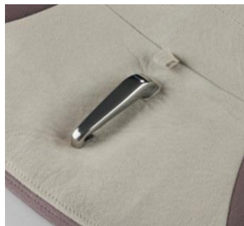
2. 通常通りにシートベルトを締めた後、お腹側のベルトを座面のフックに掛け、シートベルトが太ももをサポートするように張りを調整し、固定します。
