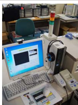
ドライバー側の IT 点呼設備。 アルコールチェッカー（右下）
