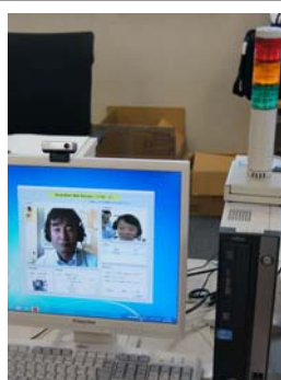
運行管理者側の設備。アルコール反応があればランプ点灯
