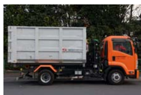
取り付け車種② コンテナごと回収するアームロール車
