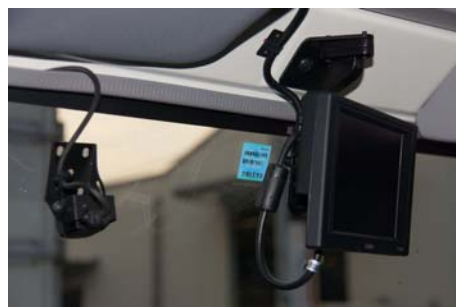
ドライブレコーダー用カメラ(左)とバックモニター(右)
