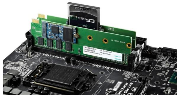
SSD オプションとして、Intel 社がタブレット PC やウルトラブック、シンクライアント向けに開発した次世代 SSD インターフェース規格 M.2 NGFF は片面 2.75mm の薄さ、かつメカニカル部品をもたないインターフェースであり、最大容量 256GB の 2242/2260/2280 の 3 モデルから、また CFast は CFast2.0 規格に準拠した最大 128GB の容量にまで対応することができます。
