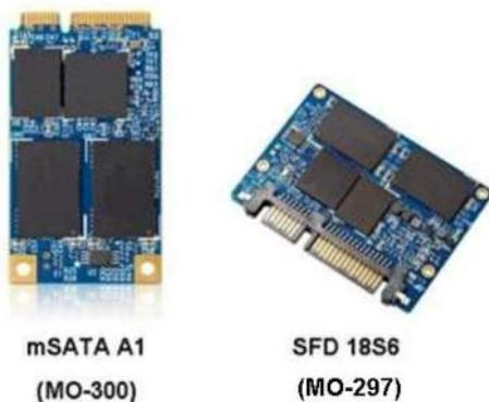
SATA 3.0 の高速転送インターフェースと 1xnm Toggle DDR 2.0 NAND フラッシュチップの採用により、SFD18S6 と mSATA A1 SSD は最大 530MB/秒、445MB/秒のシーケンシャル R/W 性能、最大 76K IOPs と、パフォーマンスに優れるだけでなく、SLC による高信頼性かつ-40°C～85°C の拡張温度動作にも対応しました。パフォーマンスとコストのバランスから、高コスト効果の MLC ソリューションも用意されており、最大 530MB/秒、460MB/秒のシーケンシャル R/W、最大 79K IOPs を実現しています。SLC、MLC のそれぞれで最大 256GB の容量に対応し、大容量かつハイスピードのトータルパフォーマンスに優れた製品です。
