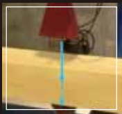
マイクロ波含水計により含水率を算出
