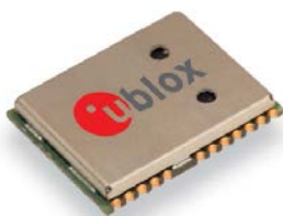
NEO-M8L モジュールの 3D ADR 技術と内蔵センサーにより、衛星の可視性には関係なく車両の正確な測位が常に可能です
