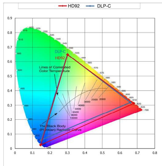
光の 3 原色が独立した LED 光源は、一般的な水銀ランプに比べ純度が非常に高く、あたかも CRT (三管式) のような色彩調整を可能にし、ユーザーの好みの画像を、より生き生きした表現力で調整が行えます。
