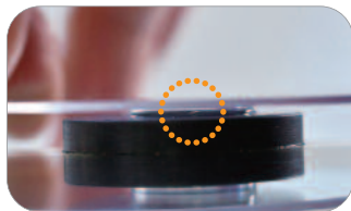
②上からプレパラートを(空気が入らないように)乗せます。観察物によっては手で少しプレパラートを浮かせてピンツ調節を行った方がよい場合もあります。
