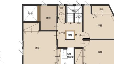
家の中心に、小さいながらも吹き抜けを設けることで、これまで各階ごとに断熱された空間につながりを生み、上下階の空気の流れや、上下階の人の気配感を生み出すことができる。
