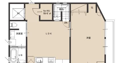
水廻りを北側にまとめて、東西方向の採光・通風を確保している。
