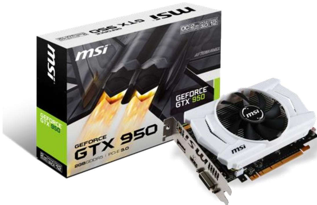
GPUには、768基のCUDAコアを備えたGeForce GTX 950を採用し、ベースクロック1076MHz、GPUブーストクロック1253MHz(最大)のオーバークロック動作を実現。メモリには6600MHz動作のGDDR5を2GB搭載し、DisplayPort、HDMI、DL-DVI-Iの3系統ディスプレイ出力に対応します。その市場想定価格(税別)は、19,800円となる見通しです。
