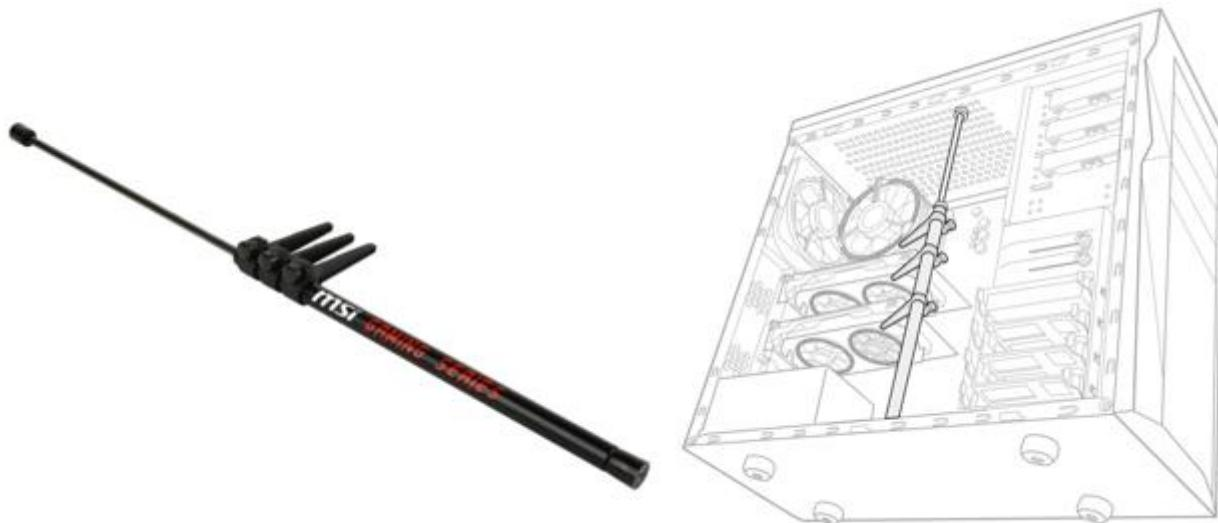
この「MSI 特製 GAMING つっぱり棒」は、突っ張り棒のようにすることで、最大 3 基のグラフィックスカードを支えるリテンションキット。重量級グラフィックスカードを複数枚支えても、ケース内でしっかりと固定できるように、伸延部には空気式スプリングを採用し、ケースの上下に十分なテンションをかけて「MSI 特製 GAMING つっぱり棒」自身を固定できるようにしています。また、ケースとの接触面には防振性ラバーを備えており、しっかりととした固定を実現するだけでなく、共振によるノイズの発生も最小限に抑えます。本製品の長さは、短縮時 390mm、伸長時 680mm で、Micro-ATX ケースから大型のゲーミングケースまで、幅広い PC ケースに対応できます。また、将来的なマルチグラフィックス環境構築も柔軟にサポートできます。
