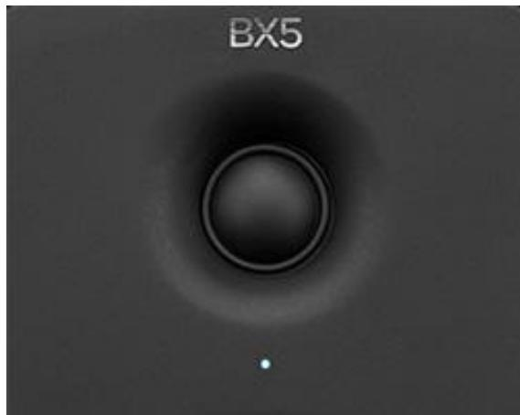
天然シルク素材で作られた高周波ドームには、他のモニターでしばしば使われる金属素材特有の共鳴音がありません。高周波ドライバーは、エンクロージャーから分離されているため、歪みが最小限に押さえられ、最高 22kHz の極めて滑らかな周波数特性を提供します。また、内蔵のウェーブガイドにより、正確な音像再生を実現しています。
