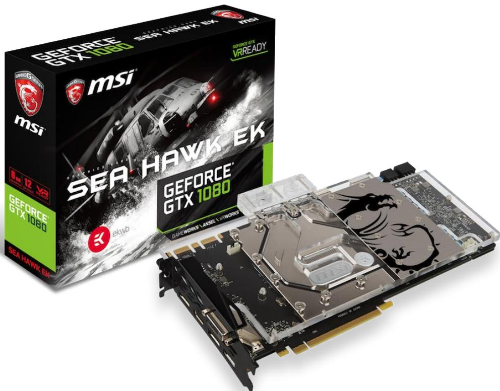
本製品は、GeForce GTX 1080 GAMING X 8G の基板をベースに、GPU コアだけでなく基板全体を冷却できるフルカバータイプの EK 製ウォーターブロックをあらかじめビルトインしたモデル。ウォーターポンプ・ラジエター・リザーバー等の水冷用パーツを別途用意するだけで、グラフィックスカード自体になんら改造を加えることなく水冷システムを構築できます。本ウォーターブロックは、中央注入式分流冷却デザインを採用しており、流量の少ないウォーターポンプを使用した場合でも、効率的な冷却が可能となっています。
