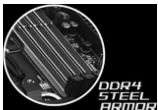
より優れたパフォーマンスと安定性を実現すべく、DDR4 メモリ回路を他の回路と分離することで、安定した信号伝達を実現し、パフォーマンスを向上させる DDR4 BOOST を採用。また、メモリスロットにスチール製のシールドを施すことで、EMI 干渉を低減させるのみならず、重量級の OC メモリをより強固に支え、メモリモジュールのパフォーマンスを最大限引き出します。
