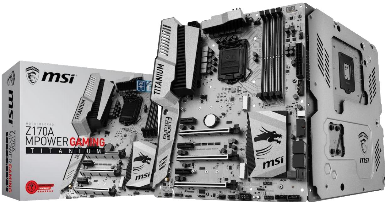
一方、Z170A MPOWER GAMING TITANIUM は、現行の Z170A XPOWER GAMING TITANIUM の持つ豊富なオーバークロック機能を簡略化する一方で、重量級のグラフィックスカードや大型 CPU クーラーの影響による基板のたわみを防ぐ TITANIUM バックプレートを搭載するなど、ハードコアゲーマーの要求を満たす、高性能マザーボードです。本製品は、2 つの STEEL ARMOR 搭載 Turbo M.2 スロットを装備するほか、Turbo U.2 ポートも標準装備。また、フルカラーRGB LED ストリップを接続し、アプリから発光パターンなどを制御可能な Mystic Light Extension を装備します。
