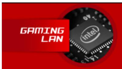
ギガビット LAN コントローラには Intel I218-V を採用しすることで、安定性にすぐれ、かつレイテンシの低い接続を実現。さらに、Intel と MSI が共同開発した MSI GAMING LAN MANAGER により、ゲームに優先的に帯域を割り振ることも可能です。さらに、LAN ポートには落雷などの電気的ダメージから回路を守る LAN PROTECT を装備し、最大 15kV のサージをサポートします。
