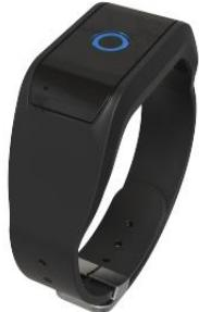
2016 年秋に発売される RiskBand は、小型でプレスレット型のデバイスで、装着者はボタンを 1 回軽く押すだけで、助けを呼んだり、音声や写真のストリーミングを行うことができます。これに使用されるユーブロックスの新製品 SARA-U201 は、世界最小のペンタバンド対応 HSPA/GSM セルラー・モジュールです。これにより、装着者はセルラー・サービスが利用可能な世界中のどこからでも RiskBand Emergency Response チームに連絡することができます。RiskBand は、世界中どこでも機能するセルラー・モジュールを内蔵した最初のデバイスの 1 つです。
