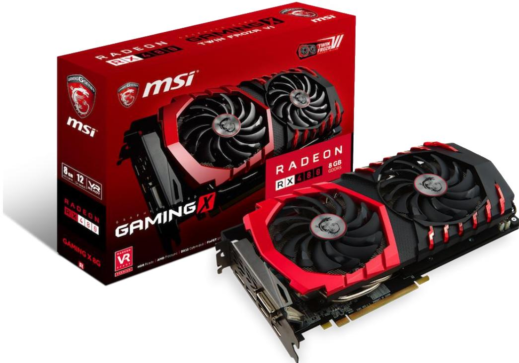
本製品は、リファレンス設計のブーストクロック 1266MHz を上回る 1316MHz による動作を実現するとともに、メモリクロックも 8000MHz から 8100MHz にオーバークロックすることで、Radeon RX 480 の性能をさらに引き出しています。冷却機構には、従来型ファンブレードと、よりひねりの大きな羽根を用いることでエアフローを加速し、冷却効率を上げる分散型ファンブレードを組み合わせた「トルクスファン」を改良し、風圧を 22% 向上した「トルクスファン 2.0」を採用。また、GPU ベース接地面のヒートパイプを方形にすることで熱伝導効率を高めたスムース・ヒートパイプや、ヒートシンクの形状を工夫することで、より多くの空気をヒートパイプにもたらすエアフローコントロールテクノロジーを採用した最新冷却機構 TWIN FROZR VI を搭載。オーバークロック動作時でも、GPU を十分に冷却し、静音性を高めます。また、低負荷時にはファンの動作を停止する Zero Frozr もサポート。高性能でも、より静かなグラフィックス環境を構築することが可能です。
