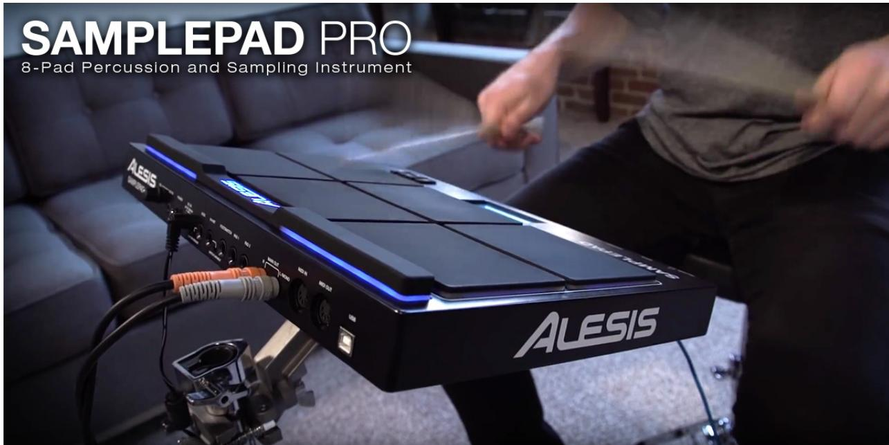
SamplePad Pro は、内蔵サウンドに加え、オリジナルのサンプル音を SD カードで追加できるプロフェッショナル・ドラムパッド・コントローラーです。計 8 つのパッド、2 つの外部トリガー入力端子、キック及びハイハット用のペダル入力端子、MIDI 入出力端子、USB MIDI 端子など、豊富な機能、拡張性に加え、200 ものドラム & パーカッションサウンドを内蔵。また、メトロノーム機能や外部音声入力端子も装備していますので、スマートフォンや携帯音楽プレーヤーの音楽に合わせての演奏・練習も可能。
