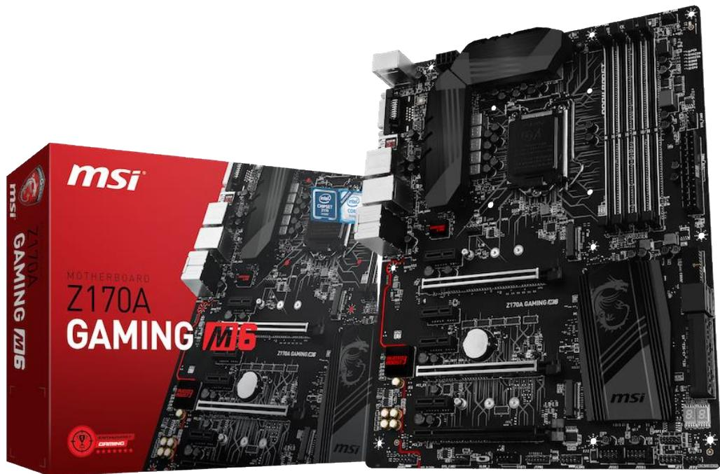
現在多くのマザーボードが採用している ASMedia Technology 社(以下 ASMedia)の ASM1142 USB 3.1 コントローラチップは、PCI Express 2.0 x2 (10Gbps) または PCI Express 3.0 x1 (8Gbps) で接続されるため、USB 3.1 Gen2 の転送速度 (10Gbps) のフル性能を発揮できない場合がありました。そこで、MSI は世界で初めて ASMedia の最新 USB 3.1 Gen2 コントローラ ASM2142 を採用した Lightning USB 機能を Z170A GAMING M6 に搭載することで、この問題を解消しました。ASM2142 は、PCI Express 3.0 x2 接続をサポートすることで、最大 16Gbps のスループットを実現し、Z170A GAMING M6 の Type-C と Type-A の 2 つの USB 3.1 Gen2 ポートにデバイスを接続しても最大限のパフォーマンスを発揮できるようになります。
