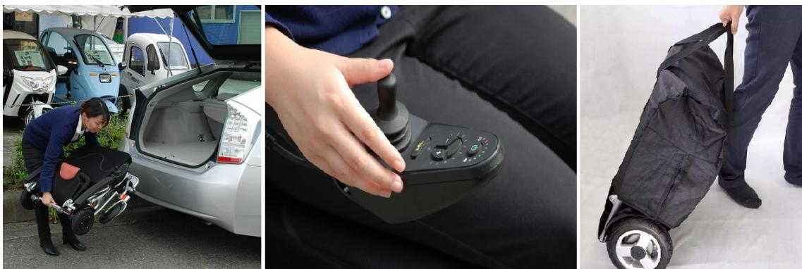
株式会社アクセスは、2016年10月11日より電動車いす「パセリミニ(SC-001)」を販売開始します。アクセスでは電動シニアカーを販売して10年になります。この間お客様からの「自動車のトランクに乗せて持ち運び可能な電動車いす」をと言う要望を何度も頂きましたがなかなか実現しませんでした。今回販売開始する「パセリミニ」は電池を含めて20Kg以下(10Kgのお米2袋分の重さ)で工具なしで折りたたみ・展開が可能です。パセリ、パセリIIとの違いは、モーター出力を400Wから200W2モーターに変更しハンドル型からジョイスティック型にしてバッテリーもリチウム電池を搭載することで軽量化が実現しました。販売の際に電動車いす安全普及協会制作のDVD「電動車いす安全運転のすすめ」が全車に付属します。
