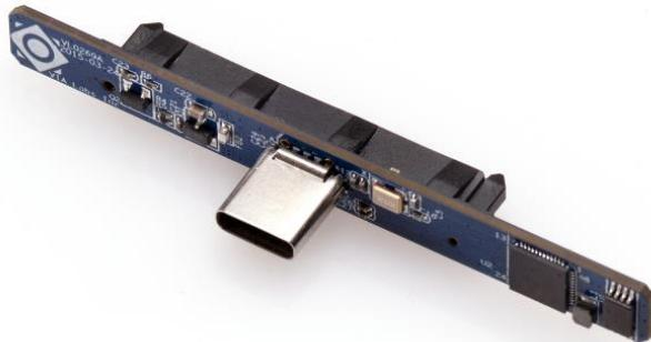
Type-C™光学ドライブや、SSD、HDDなどの最新USB Type-C™外付けストレージ用途に最適化したVL716シングルチップUSB 3.1 Gen2 – SATAIIIブリッジコントローラは、最大10Gbpsの高速なデータ転送をサポートするほか、USB 3.1 Gen1 や、従来のHigh-SpeedモードやFull-Speedモードとの互換性を保っています。さらに、VL716は、ネイティブUSB Type-C™サポートにより、USB MuxとType-C™の特徴でもある、逆挿し可能なコネクタへの対応を追加コストなしで実装することが可能です。
