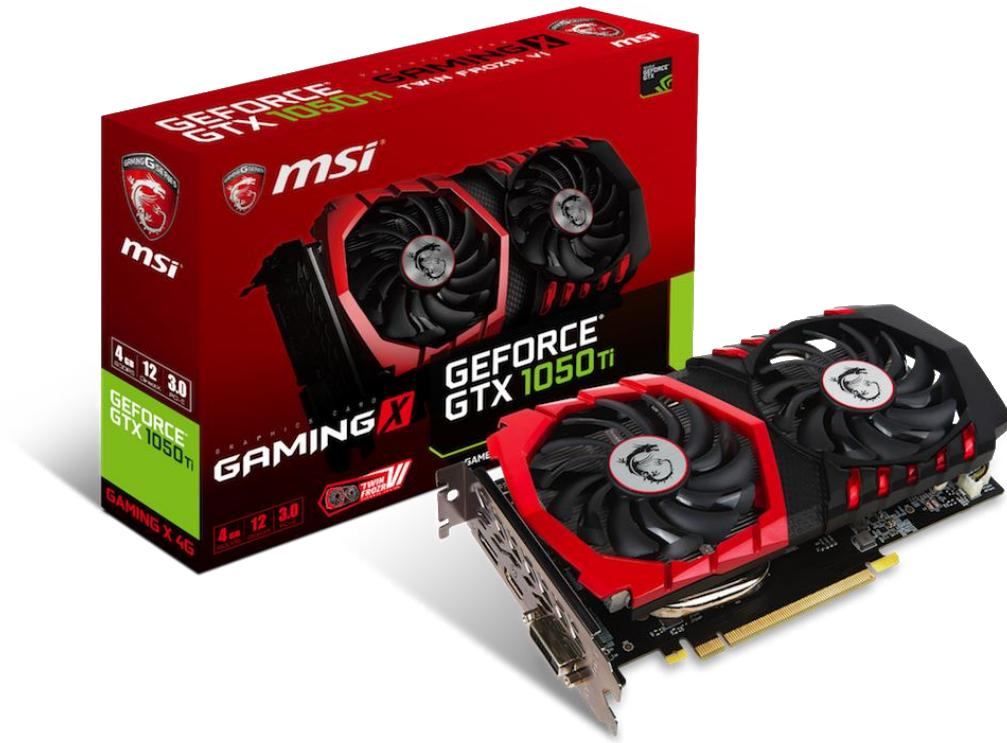
MSI 独自の冷却機構 TWIN FROZR VI は、従来型ファンブレードと、よりひねりの大きな分散型ファンブレードを組み合わせることで風圧を高め、冷却性を向上させた「トルクスファン 2.0」を採用し、高性能と静音性を両立しています。また、低負荷時にはファンの動作を停止する Zero Frozr もサポートしており、静音性に優れたゲーム環境を構築することができます。また、本製品付属の GAMING APP では、より高いクロックと積極的なファン活用により最大限のパフォーマンスを引き出す「OC モード」、ゲーム中のパフォーマンスと静音性をバランスよく実現する「ゲーミングモード」、
