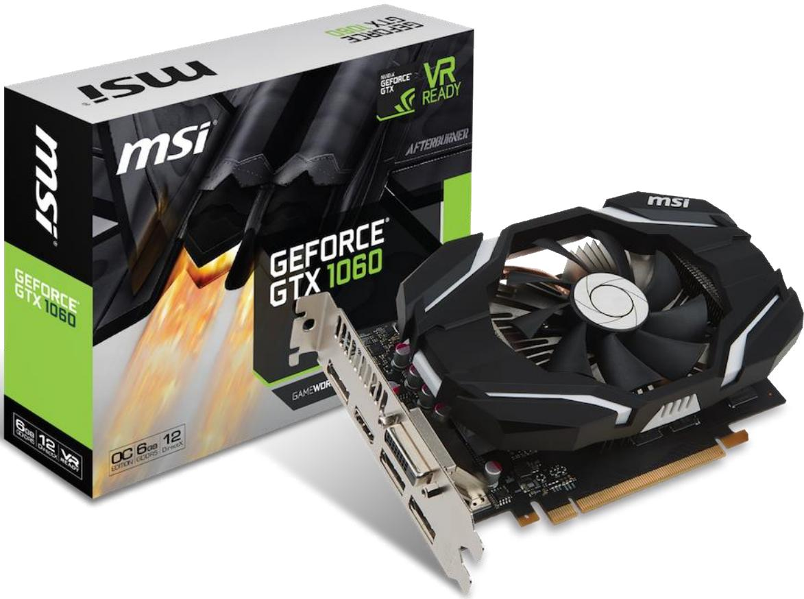
2 モデルとも、GPU には Pascal アーキテクチャを採用し、16nm FinFET プロセスで製造する GP106 コアを採用しますが、その CUDA コア数は 6GB 版の GP106-400 が 1280 基なのに対し、3GB 版の GP106-300 は 1152 基の構成を採っています。GPU コアのベースクロックは 1544MHz、GPU ブースト時の最大クロックは 1759MHz と共通で、メモリも 8008MHz 相当で動作する GDDR5 メモリを採用。ショート基板とシングルファンの組み合わせにより、カード長は 188mm に抑えながらも、ARMOR 2X 搭載モデル同等のグラフィックス性能を実現しています。本体重量は 484g で、最新ゲームタイトルも楽しめる小型・軽量のグラフィックス環境を構築することが可能になります。
