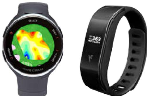
新製品第一弾の T3 はゴルフ用ハイブリッド GPS ウォッチで、GPS/QZSS または GLONASS 衛星システムとリンクする小型の Professional グレード GNSS チップ [u-blox UBX-G7020-KT](#) を使用しています。第二弾の B1 は GPS リストバンドで、業界最高のナビゲーション感度と業界最小の
