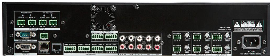
DN-508Mxa は、6 チャンネルのマイクまたはライン入力と 4 つのステレオソースを、最大 8 つのゾーンにルーティングするための、4 ゾーンアンプ搭載プロフェッショナル・8 ゾーンミキサーです。
