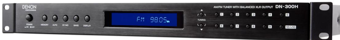
DN-300H は、AM/FM それぞれ 20 局を保存可能なプリセット機能を搭載した業務用デジタル AM/FM ラジオチューナーです。ワイド FM にも対応した PLL シンセサイザー・チューナーで、精度の高いチューニングが可能です。1U サイズのボディ背面には、XLR バランス端子と RCA アンバランス端子のステレオ出力端子を備え、様々な設備システムに組み込み可能です。
