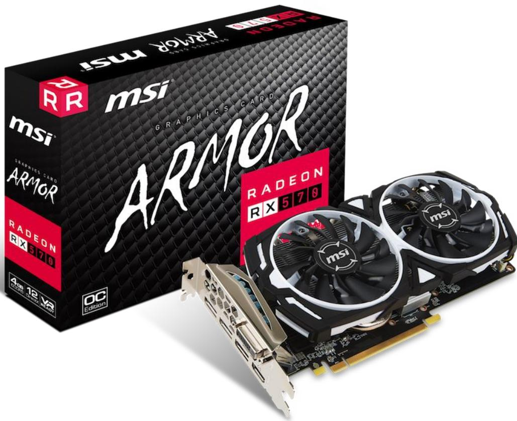
本製品は、GLOBALFOUNDRIES の 14nm FinFET プロセス技術により 2048 基のストリーミングプロセッサを統合した Polaris 20 XL チップを採用し、7000MHz 相当で動作する GDDR5 メモリを 4GB 搭載、GPU オーバークロックも 1268MHz にオーバークロックさせたモデルです。冷却機構には、分散型のファンブレードと通常のファンブレードを交互に組み合わせることで、ヒートシンクに効率的なエアフローを供給できるトルクスファンを 2 基搭載した ARMOR 2X を採用。また、GPU の温度が 60°C 以下ではファンの動作を停止する Zero Frozr もサポートしており、高性能と静音性を高いレベルで両立させています。
