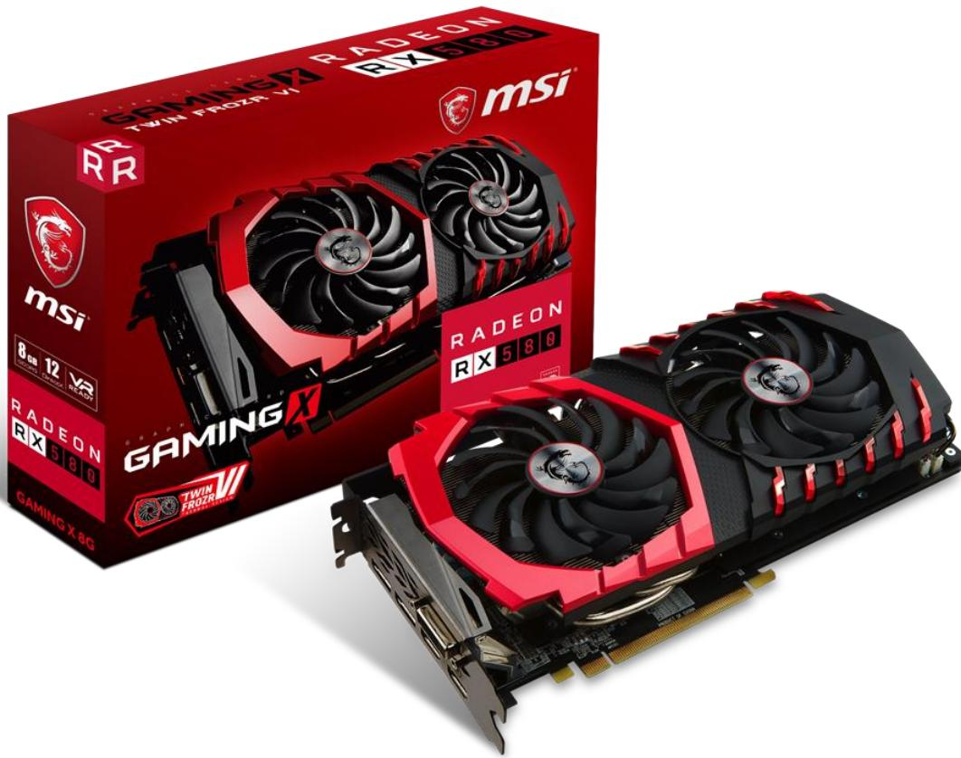
本製品は、14nm FinFET プロセス技術により 2,304 基のストリーミングプロセッサを統合した Polaris 20 XTX チップを採用し、より高速な GDDR5 メモリ 8GB を組み合わせることで、OC モードでは、GPU コアクロック最大 1393MHz、メモリクロック最大 8100MHz 相当を実現。TWIN FROZR VI に採用された、分散型のファンブレードと通常のファンブレードを交互に組み合わせ、ヒートシンクにより高い風圧と風量を供給する 2 基のトルクスファン 2.0 により、効率的な GPU 冷却を実現し、安定したオーバークロック動作を可能にしています。また、GPU の温度が 60°C 以下ではファンの動作を停止する Zero Frozr もサポートしており、高性能と静音性を高いレベルで両立させています。
