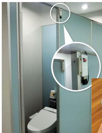
トイレのドアに取り付けたセンサによってトイレのドアの開閉をセンサで検知しサーバへ送信、送信された情報をアプリケーション側に連携して、トイレの空き状況を視覚化します。トイレに足を運ぶことなく空き状況が確認できるため、商業施設やテーマパークなどでのトイレの混雑緩和を目的とした活用が考えられるほか、防犯や介護事業などへの応用も期待できます。
