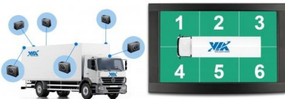
本キットは運輸・交通事業者がリアルタイムの追跡、記録、資産管理のための車両とドライバのデータを収集して分析できるようにするクラウドポータルのVIA Mobile360 E-Trackにも対応。さらに、最大2台のFOV-50カメラを追加することで、ドライバ監視、貨物監視、ライセンスプレート検出などのE-Trackコンピュータビジョン機能を拡張することもできます。
