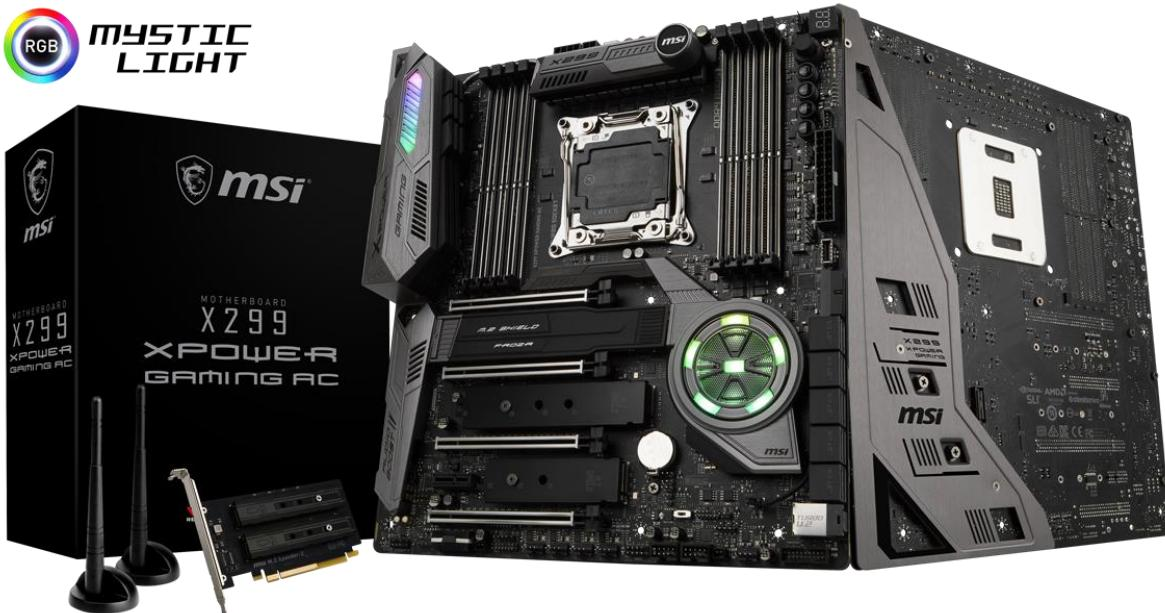
ネットワーク機能には、Intel I219-V と Intel I211 の 2 つのギガビット LAN コントローラを搭載するほか、無線 LAN 機能としてデュアルバンド IEEE 802.11ac と Bluetooth 4.2 にも対応した Intel Dual
