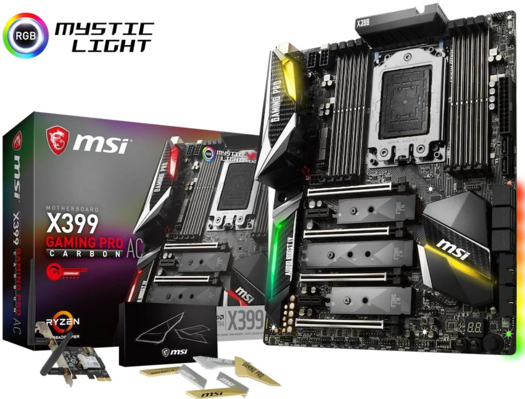
X399 GAMING PRO CARBON AC は、Performance GAMING シリーズの特徴でもある、MSI 独自の LED ライティング機能「Mystic Light」を活かし、ヒートシンクに RGB LED を搭載することにより、ユーザーのスタイルに合わせたイルミネーション効果を楽しむことができます。また、ヒートシンクカバーは交換が可能で、標準装備のカーボンタイプに加え、金と銀のカバーも付属。さらに、3D プリンタを利用してオリジナルの拡張パーツを作ることができる 3D X マウンティングをサポートし、自分だけの GAMING システムを作ることが可能です。
