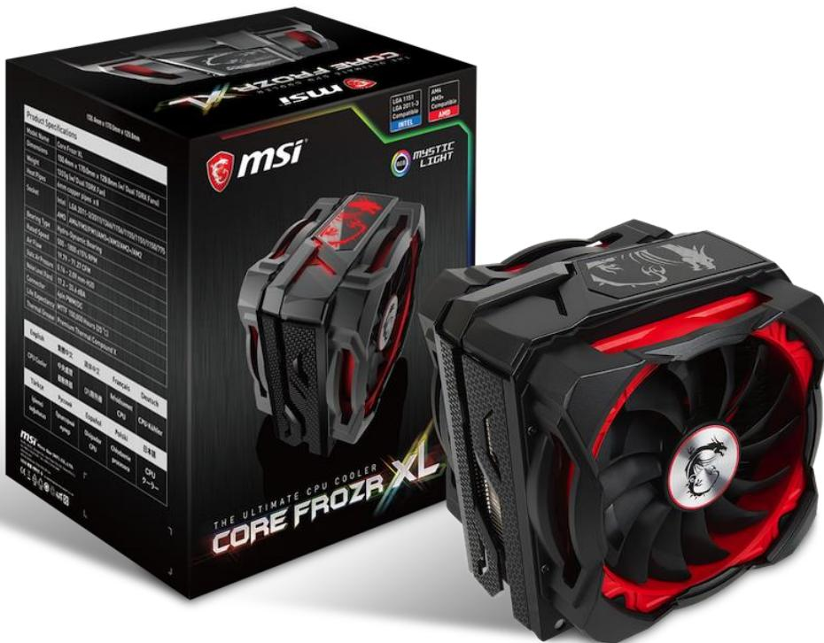
本製品は、ニッケルメッキを施した銅製 CPU ベースプレートと 8 本の 6mm 径銅製ヒートパイプ、散熱性に優れたアルミフィンからなるヒートシンク部に、MSI GAMING シリーズグラフィックスカードでおなじみの「トルクスファン」を 2 基搭載。従来型ファンブレードと、よりひねりの大きな分散型ファンブレードを組み合わせることでエアフローを加速し、ヒートシンクからの冷却効率を高めます。また、熱伝導効率にすぐれた伝導剤 PREMIUM THERMAL COMPOUND X が同梱されています。
