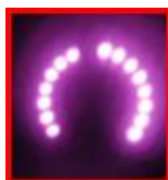
← ドーム型：ES-CD136SW/C の赤外線LED作動時の様子 （赤外線照射距離15m）
