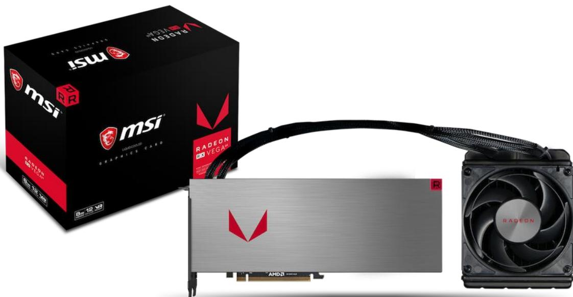
本製品のGPUには、4096基のストリーミングプロセッサを統合したRadeon RX Vega 64の中でも、より高クロックで動作する開発コードネーム Vega 10 XTX コアを採用することで、空冷モデルよりも高い、ベースクロック1406MHz、ブーストクロック1677MHzでの動作を可能にしています。また、従来のグラフィックスメモリにあたる High-Bandwidth キャッシュには HBM2 メモリを8GB搭載し、2048bit幅のメモリインターフェースを採用することで、484GB/sのメモリ帯域を実現。最新のVRコンテンツも快適にプレイできるパフォーマンスを実現しています。
