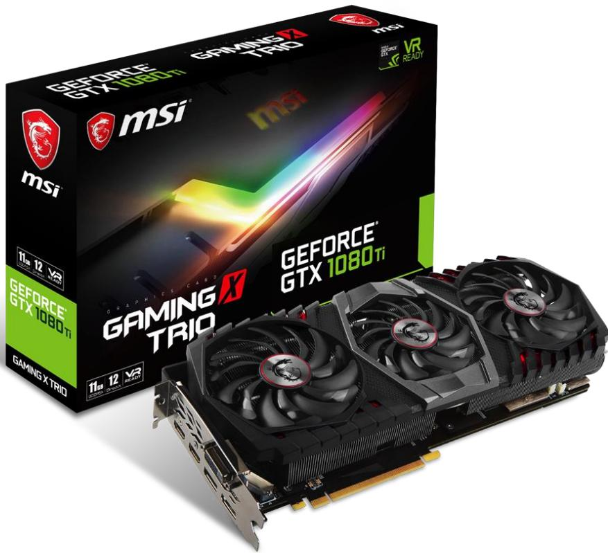
本製品は、3584基のCUDAコアを実装したGP102-350チップを採用し、LIGHTNINGシリーズのデザイン要素を取り入れたTRI-FROZRを採用。分散型のファンブレードと従来型のファンブレードを組み合わせ、当社従来品と比べ風圧を22%、風量を13%向上させた独自ファンの「トルクスファン2.0」を3基搭載するほか、ファンの軸受けにはダブルボールベアリングを採用することで、よりスムーズな動作と、すぐれた耐久性を実現しています。また、ヒートシンクのフィンに波形加工を施すことで表面積を拡大し、従来の同形状のヒートシンクより散熱性を約10%向上させています。ヒートパイプには8mm径のスーパーパイプ2本と、6mm径のヒートパイプ4本の計6本を搭載し、銅製GPUベースプレートへの接地面を平滑にすることで、オーバークロック動作時でも、すぐれた冷却性を実現します。さらに、GPU温度が60°以下の低負荷時には、ファンの動作を停止するZERO FROZRもサポートしており、静音性にもこだわっています。
