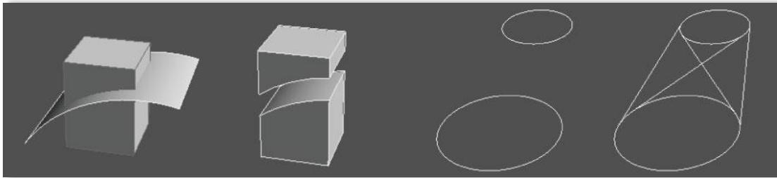
面での切断は曲面での切断も可能になり、「円の外接線」にて、円同士の外接線作成時にクロスラインを作成するオプションを追加しました。※Professional版にのみ搭載
