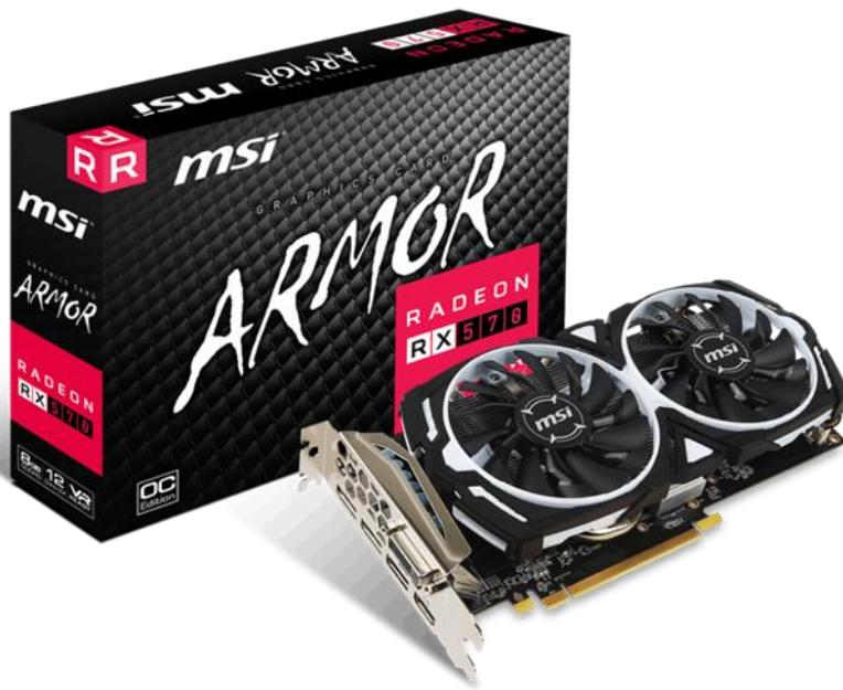
本製品は、14nm FinFET プロセス技術により 2048 基のストリーミングプロセッサを統合した Polaris 20 XL チップを採用し、同 CPU の定格よりも高い 1268MHz のオーバークロック動作を実現。メモリには、負荷の高い最新ゲームタイトルをより高解像度でも楽しめるよう、7000MHz 相当で動作する GDDR5 メモリを 8GB 搭載。最新 VR タイトルのプレイ環境としても最適です。冷却機構には、分散型のファンブレードと通常のファンブレードを交互に組み合わせ、より高い風圧と風量をヒートシンク部に供給するトルクスファンを 2 基搭載するデュアルファン構成を採り、効率的な GPU 冷却を実現するとともに、安定したオーバークロック動作を可能にしています。また、GPU の温度が 60°C 以下ではファンの動作を停止する Zero Frozr もサポートしており、高性能と静音性を高いレベルで両立させています。
