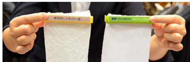
画像：洗濯後を想定した NON IRONMAX 生地と未加工生地を、吊るして乾燥させた防シワ性比較実験
