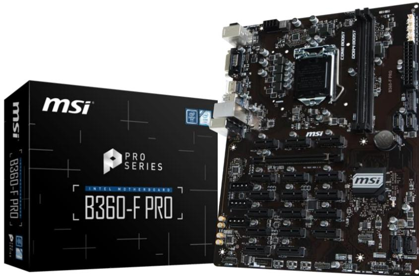
B360-F PRO は、PCI-Express 3.0 x16 スロット 1 本に加え、PCI-Express 2.0 x1 スロットを 17 本搭載するとともに、各スロットに安定した電源を供給できるよう、オンボードで 3 つの Molex 4 ピン補助電源を備え、各スロット横にデカッピングコンデンサを搭載したマイニング向けマザーボードです。ギガビットイーサネットコントローラには、信頼性にすぐれた Intel I219-V を採用し、安定したネットワーク接続をサポート。また、ディスクレスブートをサポートすることで、複数のシステムを構築する際の導入時間を節約するだけでなく、マイニングの成果を一括管理することができるため、仮想通貨保管上のセキュリティも向上させることができます。
