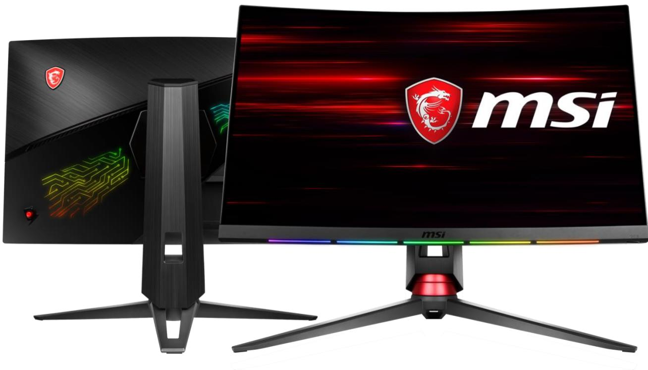
Optix MPG27CQ は、本製品は、2560×1440 ピクセルの WQHD 表示に対応した曲率 1800R(半径 1800mm のカーブ)の湾曲タイプの 27 型 VA パネルを採用し、144Hz の高リフレッシュレート表示と、最大 1ms の応答速度を実現。ディスプレイ入力には HDMI×2 と DisplayPort の 3 系統をサポートするほか、USB 3.1 Gen1 ポートを PC と接続することにより、Gaming OSD App によりモニターの各種設定をキーボードとマウス操作で簡単に最適化することができるようになります。また、コントラスト比は 3000:1、最大輝度 450cd/平方 m で、sRGB 比 115%、NTSC 比 100% の TrueColor 表示にも対応。また、Adaptive SYNC 技術に対応し、AMD FreeSync をサポートすることで、チラツキやティアリングの発生を防ぎ、なめらかなゲーム体験を楽しめます。
