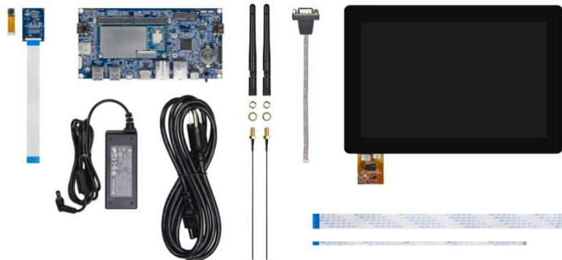
本キットは、VIA SOM-9X20 SOM モジュールと SOMDB2 キャリアボード、インテリジェントなリアルタイムのビデオキャプチャ、プロセッシングおよびエッジ解析に最適化された 13MP カメラモジュールを組み合わせています。エッジ AI アプリケーションの開発は Snapdragon Neural Processing Engine (NPE) のサポートと、AI アプリケーションを駆動する Qualcomm® Hexagon™ DSP、Qualcomm® Adreno™ 530 GPU、または Qualcomm® Kryo™ CPU のフルアクセラレーションをに対応した Android 8.0 BSP によって可能になります。また、Yocto 2.0.3 に基づく Linux BSP は、今年 6 月にリリース予定です。
