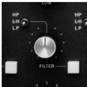
4つの入力チャンネル、およびサブミックスチャンネルにはそれぞれユニーク且つ排他的な3段階の切替スイッチを搭載します。LP(ローパス)、HP(ハイパス)、L-H(ローパスとハイパスのコンボ)を選択でき、全てのフィルターにおいてすべてが急峻な24dB / オクターブ(4ポール)のスロープを持ち、スイープ効果を与えることができます。
