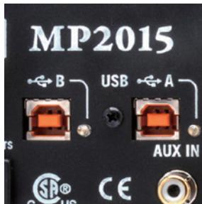
音に途切れがないDJの交代ができるようになることはこれまでのデジタルDJにおける大きな課題でした。MP2015ミキサーは2機のUSB端子を組み込むことにより、DJの交代をかつてないほどシンプルにすることに成功しました。DJが変わったとしてもDAWソフトウェアが変わったとしても一切の問題は生じません。全ての入力チャンネルにこのソース・セレクト・ノブが搭載されるため、このノブの切り替えだけで、コンピュータ間を行き来することができるのです。2つのUSB端子はそれぞれ低レイテンシーで24bit、44.1/28/96kHzの信号を24チャンネル分ストリームすることができます。最大4台のターンテーブル、4台のCDデッキを接続する、もしくは2台ずつ接続することができます。
