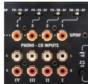
フォノ / CD (及び全てのラインレベルのソース) のアナログ入力端子はゴールドの RCA コネクターが採用されており、搭載される真のスタジオ・クオリティーのプリアンプによって電磁波、無線電波、および静電気から音質を守ります。フォノ RIAA フィルターの制度は +0.1/-0.2dB の差異に抑えます。急峻な 18dB / オクターブのスロープを備えた 18Hz ハイパス超低周波 (ランブル) フィルターと、12dB / オクターブのレートで 50kHz でロールオフを開始する超音波フィルターも搭載されています。また CD からフォノへの切替時には一切の歪みが生じません。
