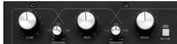
独自設計の3バンド出力アイソレーターは急峻な24dB / オクターブ(4ポール)の位相補正されたLinkwitz-Rileyデザインで継続的にLow-MidとMid-Highのクロスオーバー・ポイントを調整できます。トーン・コントロールと同様にこれらのフィルターは極めて精密で、高解像度、スピードがあり人工的な色味を持ちません。全てのフィルターは選択されたサンプルレートによってそれぞれ正確な係数で正確に計算されます。また、クロスオーバーが調節できることでアーティストがかける音楽によってマッチするアイソレータを調節することができます。
