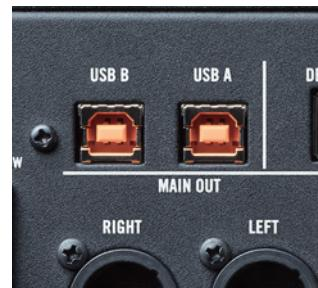
本体には2つのUSBポートが用意され、それぞれにパソコンを接続し同時に再生することができる所以、DJの交代時でも音を途切れさせることなくセットを変更することができます。
