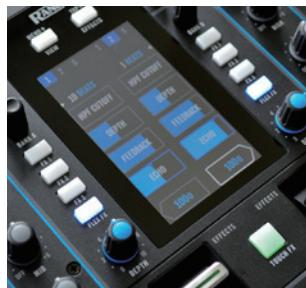
本体は2機の高性能Flex FXエンジンが搭載されます。Flex FXは、Serato DJに搭載される多彩で表現力の高いエフェクトと一緒に組み合わせて使用することができます。2機のダイカスト・アルミニウムFXトグルスイッチで、エフェクトのオン/オフの切り替えを瞬時に実行することも可能です。このトグルスイッチは、上下（常時オン/ホールド時のみオン）の機能を反転させることもできます。
