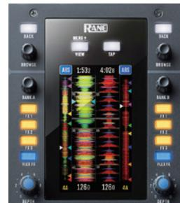
Seventy-Two は、最新の Serato DJ ソフトウェアに対応し搭載される 4.3 インチのカラータッチパネルで波形の動きを確認したり、ナビゲーション操作、トラックの選択、広範囲に及ぶパフォーマンスの微調整などを行えます。また、XY コントロールでフィルターをはじめとする各種エフェクトを操作することもできます。
