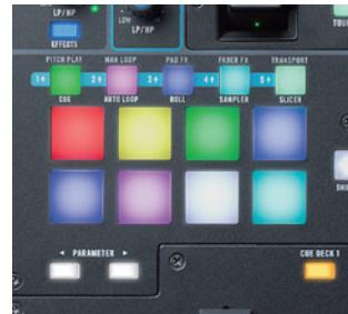
RGBバックライトを搭載するMPCスタイルのパッドではキュー、ピッチプレイ、ループ、ロール、サンプラー、など複数のパフォーマンス・モードを操作し、表現力の高い演奏を可能にします。
