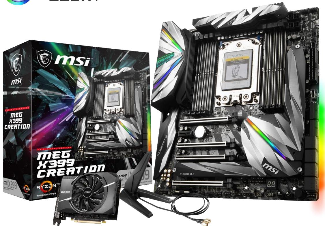
本製品は、AMD がクリエイター向けと位置づける最大 32 コア/64 スレッドを実現するフラグシップ CPU、Ryzen Threadripper WX シリーズに最適化し、250W の TDP を支えるとともに安定したブースト動作を可能にすべく、CPU 電源まわりに 19 フェーズのデジタル PWM 回路を採用し、8 ピン電源×2 による十分な電力供給を確保しました。さらに、ヒートパイプを備えたヒートシンクにより効率的な冷却を可能にすることで、CPU の性能を最大限に引き出せるようにしています。また、複数のグラフィックスカードや M.2 SSD を搭載しても、ケース内部の効率的な排熱を実現できるように、マザーボード上には 10 個の PWM ファンコネクタを装備し、それぞれのファン回転数などを制御することができます。
