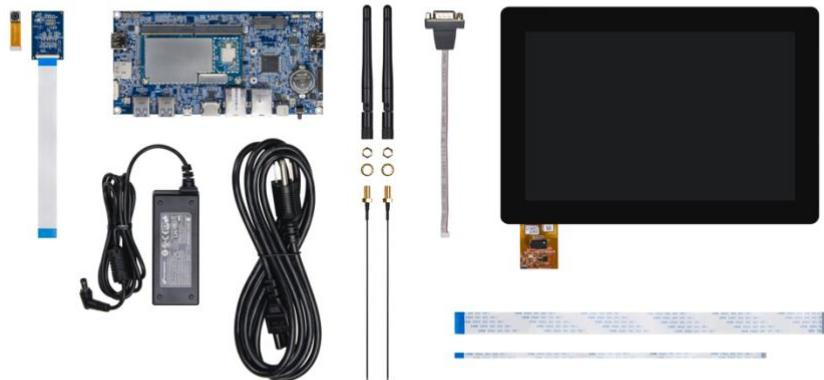
本キットは、VIA SOM-9X20 SOM モジュールと SOMDB2 キャリアボード、インテリジェントなリアルタイムのビデオキャプチャ、プロセッシングおよびエッジ解析に最適化された 13MP カメラモジュールを組み合わせています。エッジ AI アプリケーションの開発は Snapdragon Neural Processing Engine (NPE) のサポートと、AI アプリケーションを駆動する Qualcomm® Hexagon™ DSP、Qualcomm® Adreno™ 530 GPU、または Qualcomm® Kryo™ CPU のフルアクセラレーションをに対応した Android 8.0 BSP または Yocto 2.0.3 に基づく Linux BSP で可能になります。
